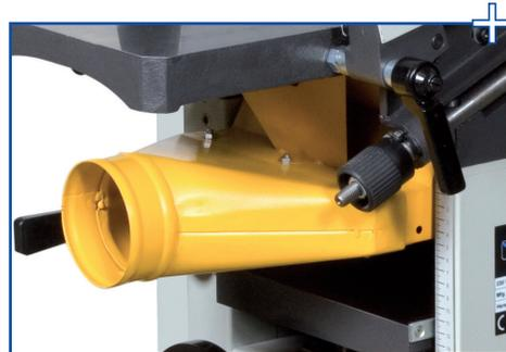
Convogliatore polveri in lamiera removibile e di grande capacità.
