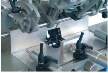
Diese Fräsmaschinen sind insbesondere für die Bearbeitung von PVC-Profilen ausgelegt. Durch die Ausrüstung mit voneinander unabhängigen Arbeitseinheiten können vorlagenfreie Profil-Fräsbearbeitungen in Längsrichtung zum Erhalt von Langschlitzen für den Kondensat- bzw. Wasserablaß ausgeführt werden. Modell ML 142 ist mit 3 Arbeitseinheiten in geneigter, bis zu 60°
