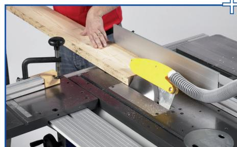
Sega circolare con carrello a squadrare e guida laterale: regolabile in altezza e inclinabile tramite comandi separati.
